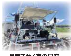
月面で動く車の研究 可動式油圧ローバー
